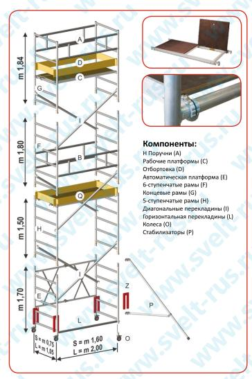
Roller Plus можно увеличить до макс. высоты 6,76 м. После модуля С, который доводит Roller Plus до 4,96 м, можно добавить последний модуль D, начиная с 1,80 м и заканчивая максимальной высотой 6,76 м (рабочая высота 7,76 м). Рамы с расстоянием между перекладинами 30 см обеспечивают безопасный проход пользователя на каждую рабочую платформу (в соответствии с европейскими стандартами) без использования внутренней лестницы.
